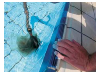
Schnell wird ein großer Teil der Haare angesaugt und in die Öffnung gezogen. Es beginnt die Verwirbelung und Verknotung.
