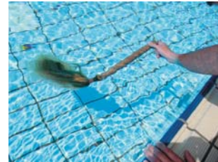
Der ecotron-Sicherheitstest in Anlehnung an DIN/EN 13451/3: Ein Haarbüschel aus Menschenhaar wird an die zu überprüfende Ansaugöffnung herangeführt
